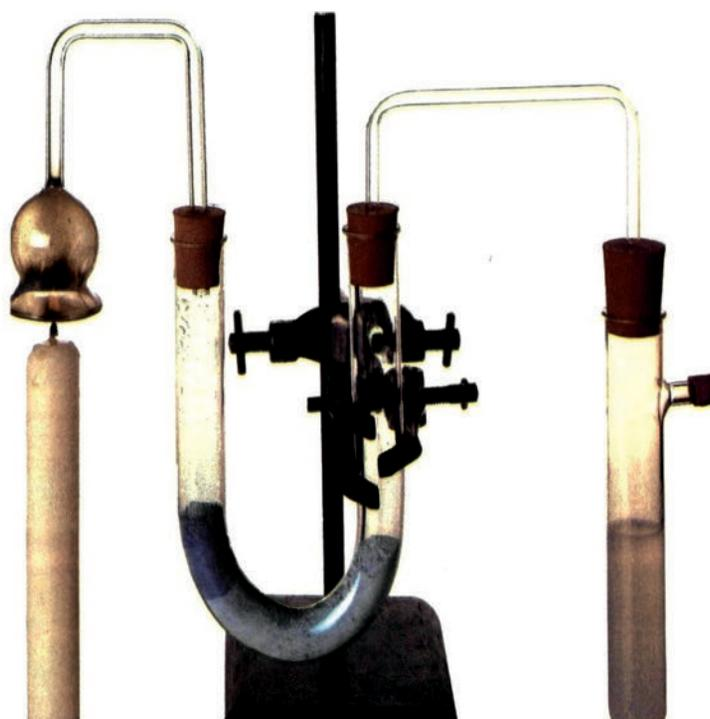
ΣΧΗΜΑ 6.4 Πειραματική διάταξη για τον ποσοτικό προσδιορισμό C και H σε κέρι (οργανική ένωση). Οι  $\text{H}_2\text{O}$  (g) δεσμεύονται από  $\text{CuSO}_4$  (μπλε στερεό) και το  $\text{CO}_2$  από διάλυμα  $\text{KOH}$ .
