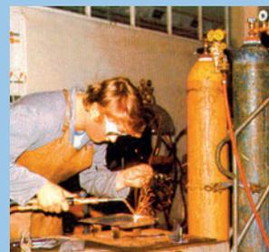
Η φλόγα από την καύση του ακετυλενίου έχει πολύ υψηλή θερμοκρασία και γι' αυτό χρησιμοποιείται για την κοπή και συγκόλληση των πολύ δύσσηκτων μετάλλων.
