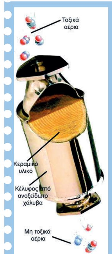
ΣΧΗΜΑ 2.8 Κατασκευαστικές λεπτομέρειες καταλυτικού μετατροπέα. Το κέλυφος είναι από ανοξείδωτο χάλυβα. Ο καταλύτης συνήθως αποτελείται από λευκόχρυσο (Pt) και ρόδιο (Rh) πάνω σε υπόστρωμα από κεραμικό υλικό με ενδιάμεση επίστρωση αλουμίνιας (Al<sub>2</sub>O<sub>3</sub>).
