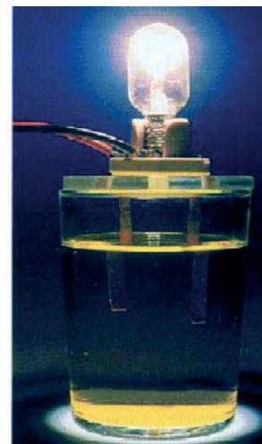
**ΣΧΗΜΑ 3.1** Πειραματική διάταξη για τη μέτρηση της ηλεκτρικής αγωγιμότητας διαλύματος. Σε διάλυμα ασθενούς οξέος η λάμπα ανάβει αμυδρά ή καθόλου. Αντίθετα, σε διάλυμα ισχυρού οξέος ίδιας συγκέντρωσης η λάμπα ανάβει έντονα.
