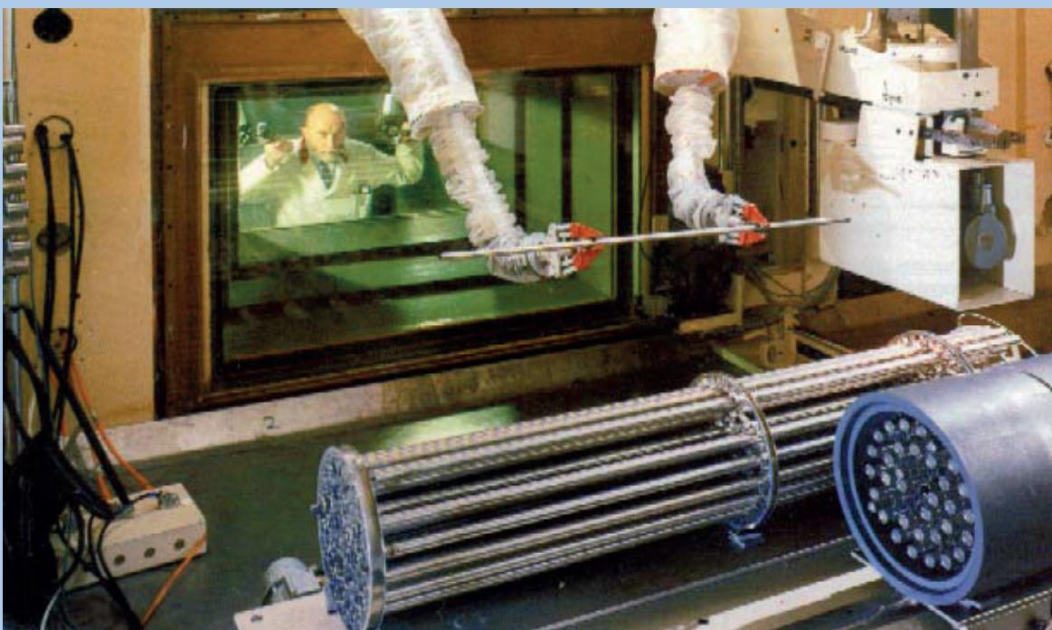
Η διαχείριση των ραδιενέργων υλικών γίνεται κάτω από δρακόντεια μέτρα ασφαλείας, όπως πχ μέσω ενός ρομποτικού συστήματος πίσω από ένα παράθυρο με γυαλί πολύ μεγάλου πάχους, όπως φαίνεται στο παραπάνω σχήμα.
